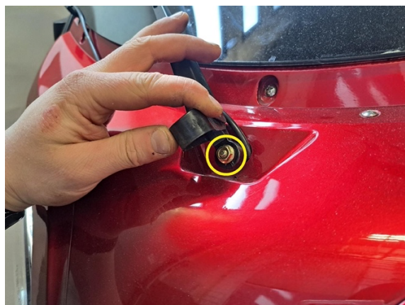
Irrota tuulilasinpyyhkijän kiinnitysmutteri. (kiintoavain 10 mm).
